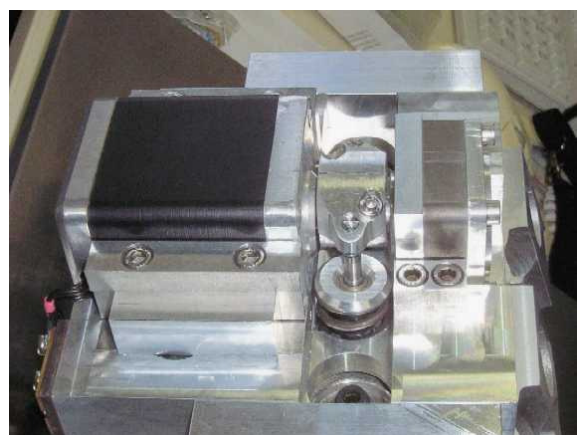
Abb. 3 Labormuster des Ventilaktuator zur Betätigung von 2 Ventilen (links: ohne „magnetische“ Feder und Gegenlager)
